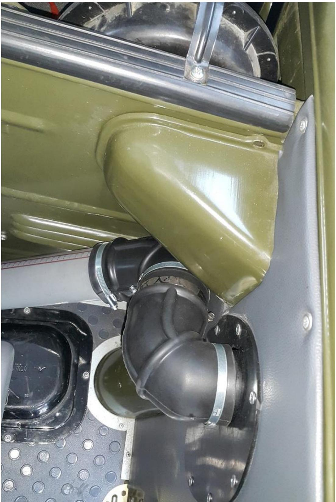
12. Одеть длинный резиновый уголок на трубу 340мм, а короткий на патрубок шноркеля. Выставить всё конструкцию вдоль перегородки салона. Протянуть хомуты.
