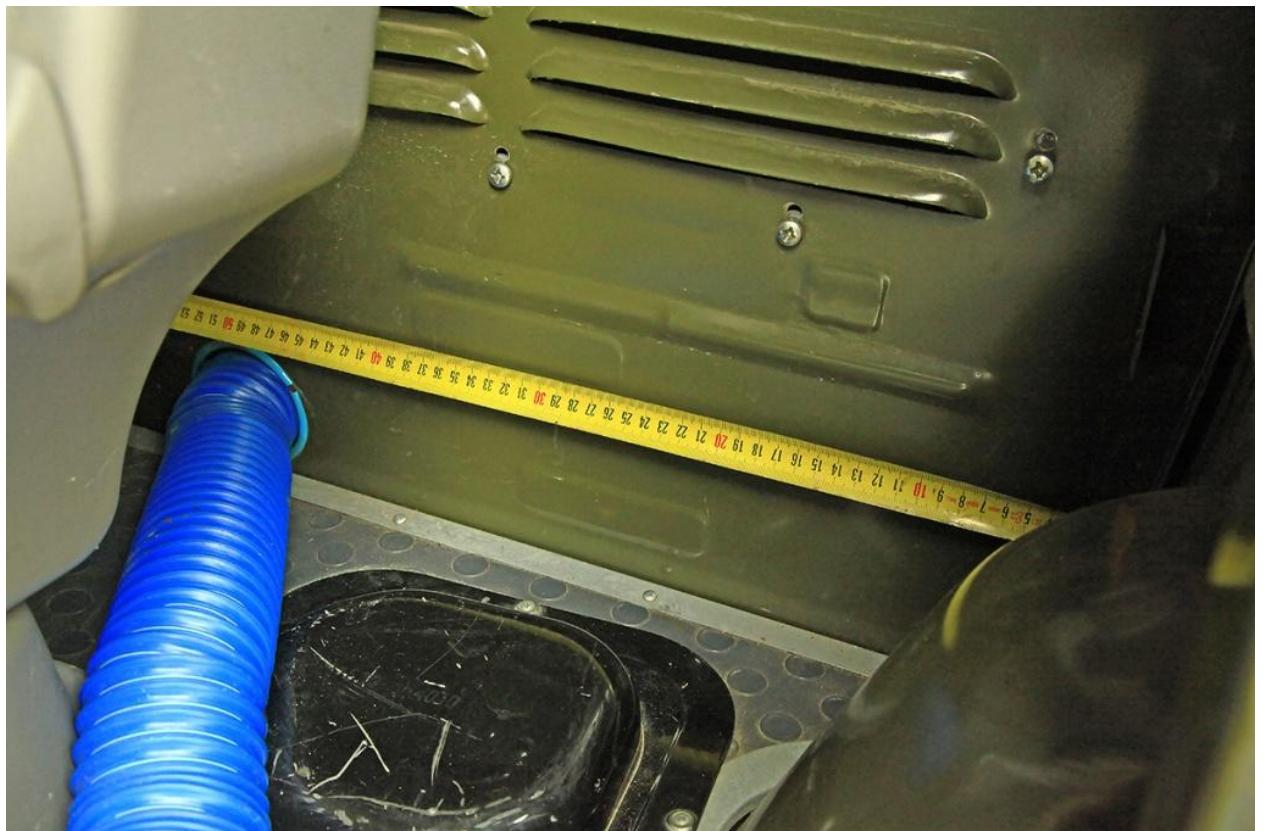
После рассверливания выполнить обработку кромки металла и одеть на неё, защитный кант.
