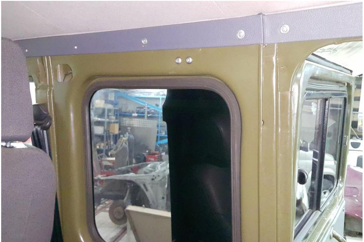
В два нижних отверстия устанавливаются болты с обычной головкой.
