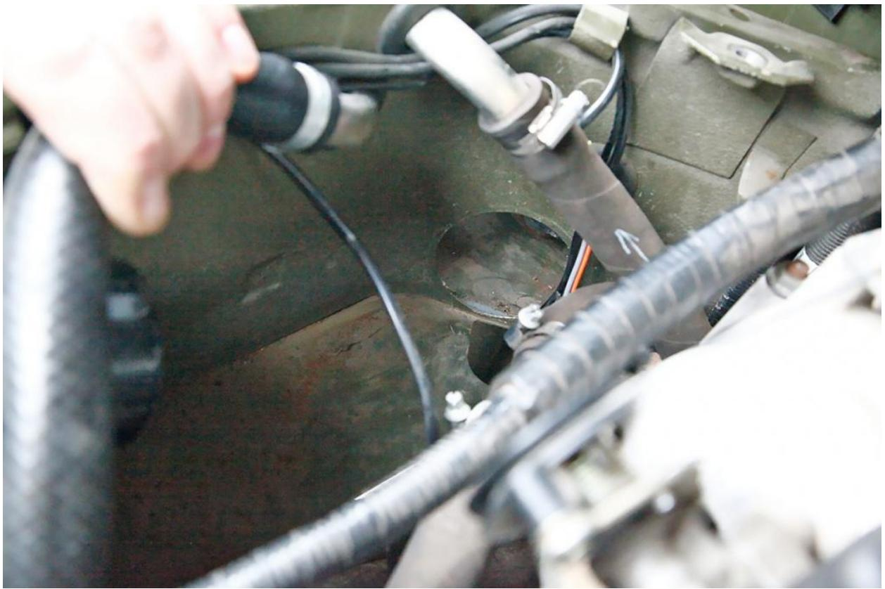
8. Протянуть гофротрубу сначала через отверстие в салоне, а потом через отверстие в моторном отсеке. Одеть хомут и зафиксировать её на корпусе воздушного фильтра.
