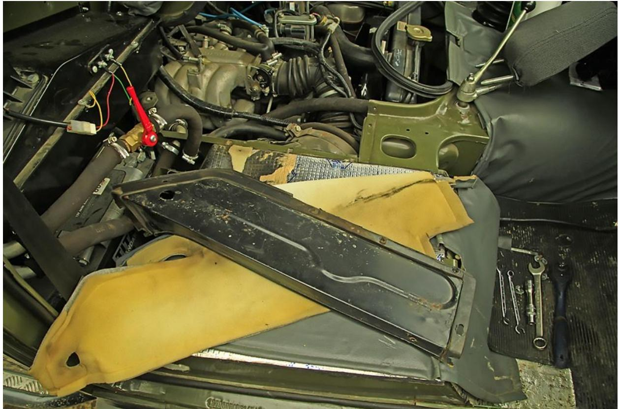
5. Просверлить коронкой по металлу диаметром 80 мм отверстие в углу ниши, над колёсной аркой в соответствии с фото. Центр отверстия должен располагаться на расстоянии 45-50мм. от горизонтальной плоскости колёсной арки. Должен оставаться небольшой бортик на который необходимо одеть защитный кант.
