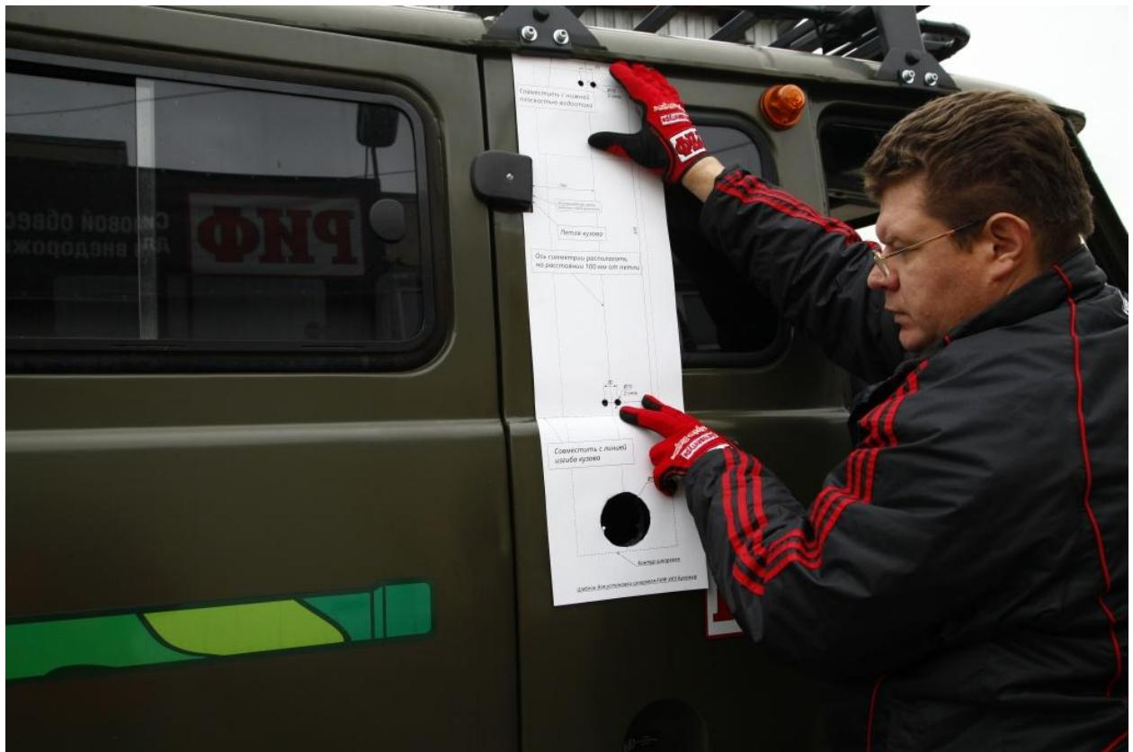
2. Просверлить 4 отверстия для крепления шноркеля сверлом диам.10мм. Два верхних отверстия просверлить насквозь до выхода сверла в кабину. Для 2-х нижних отверстий сверлится только один наружный слой металла. Просверлить отверстие для патрубка диам.76мм с помощью коронки по металлу или вырезать лобзиком.
