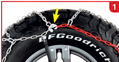
1. Плоский серебристый крюк должен находиться в верхней части колеса, для автомобилей с задним приводом и в передней части для переднего привода
