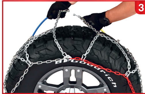
3. Поднимите вверх концы гибкого троса и соедините их
