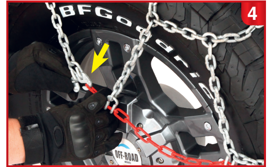
4. Соедините плоский серебристый крюк с крайним звеном красной цепи
