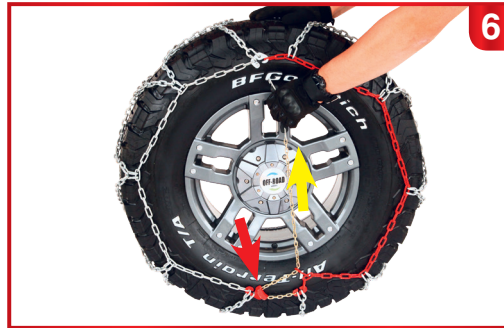
6. Пропустите натяжную цепь золотистого цвета через фиксирующую скобу красного цвета и проденьте резиновый натяжитель с цепью через красное кольцо и максимально натяните
