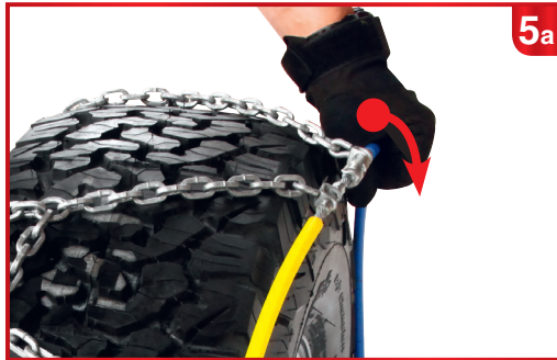
5. Заведите гибкий кабель за колесо. Убедитесь, что он не находится на протекторе шины
