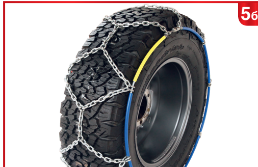
2. Протяните гибкий кабель (желтый конец) за колесо слева на право
