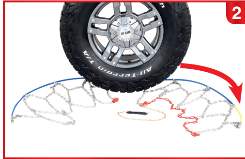
2. Протяните гибкий кабель (желтый конец) за колесо слева на право
