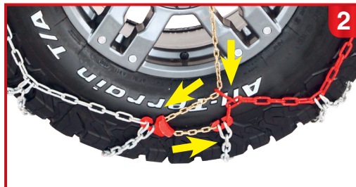
2. Отцепите резиновый натяжитель и вытяните его из красного кольца и фиксирующей скобы
