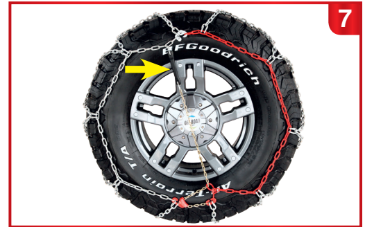
7. Закрепите за звено боковой цепи. Если нет возможности провести натяжную золотистую цепь через кольцо, то закрепите натяжитель на боковой цепи с максимальным натяжением
